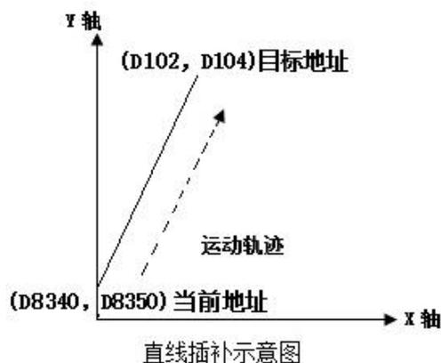
圆心插补时：D100 速度，D102 为 X 轴目标地址，D104 为 Y 轴目标地址，D106 为圆心 X 地址，D108 为圆心 Y 地址。Y0、Y1 分别给 X 轴 Y 轴发脉冲。
