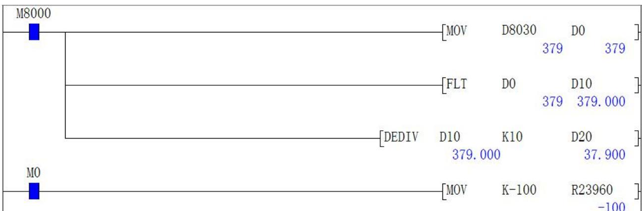
上图中当 M0 闭合时，将值-100 传送给修正寄存器 R23960，这时可以看出实际测量温度 D20 的值接近实际温度 37.9℃。
