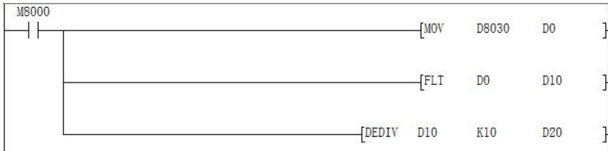
将温度传感器的信号端接入 PLC 的 AD0 输入端，另一端接入模拟量输入端口的 GND。当 PLC 运行时，AD0 对应的数据寄存器 D8030 的值将传给 D0，将 D0 的值进行浮点数运算后放入 D10，再对 D10 进行浮点数除法运算运算，运算结果放入 D20，结果 D20 就是实际温度值。在梯形图中，也可以直接对 D8030 的值进行除法运算。
