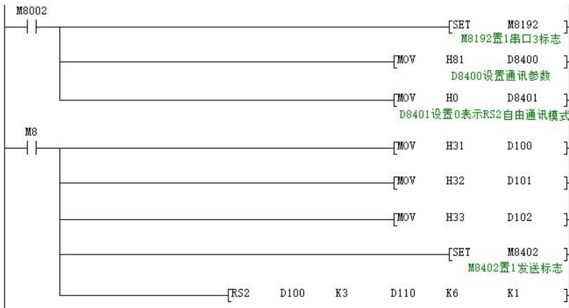
使用串口工具监控串口 3 得到的数据为：[2017:11:01:11:49:16][接收]31 32 32
