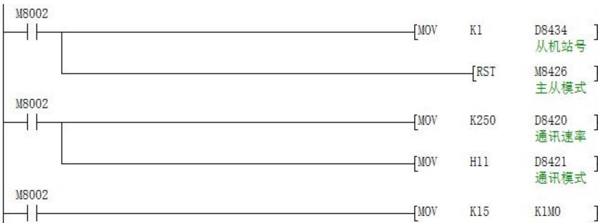
表示通过本 PLC 的 CAN 口与从 PLC 的 CAN 口通讯，读从 PLC 的 4 位 M0~M3 到主 PLC 的 D0。
