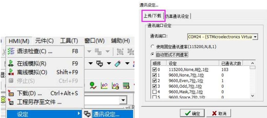
在通讯设定窗口的【上传/下载】中对 PC 端的通讯口做指定，即下载线连接在 PC 上的端口。如 COM24，可配合人机的【下载画面】选择【使用固定通讯速率】，或让 PC 自动尝试不同速率下载。
