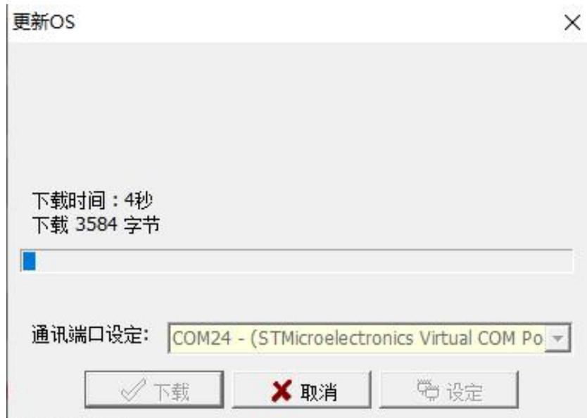
步骤四：下载完成，需重启 HMI 的电源。
