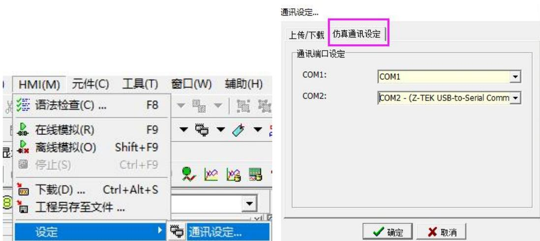
其中在【通讯设定】左边的 COM1 和 COM2 指的均是人机上面的通讯口，而右边的设定则是使用者指定由 PC 端的那组通讯口来模拟人机端的性对应通讯口，如下图：
