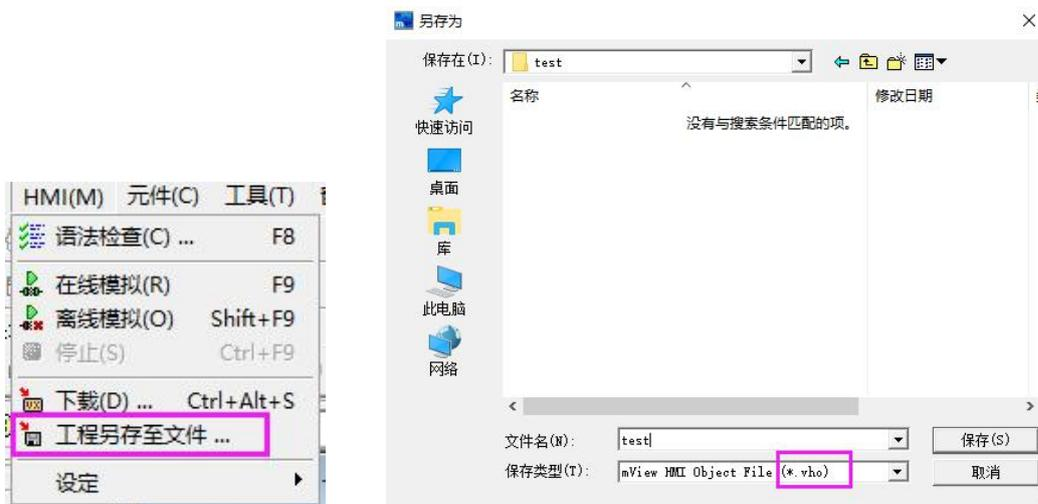
之后需要下载此程序到人机，则选择【工具】→【下载 HMI 程序】，如下图即可将此程序下载至 HMI。
