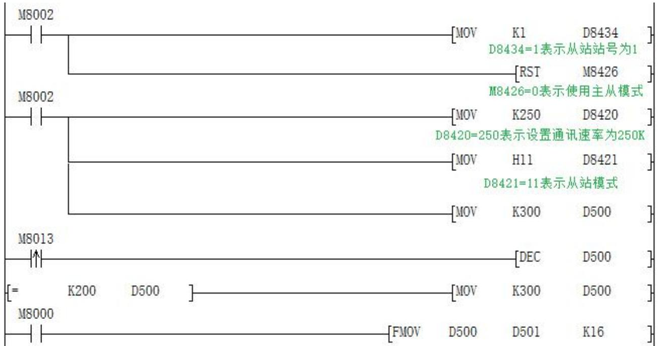
监控主站程序, 主站 D301-D316 共 16 个数据每秒减 1 的速度在 300-200 之间变换。
